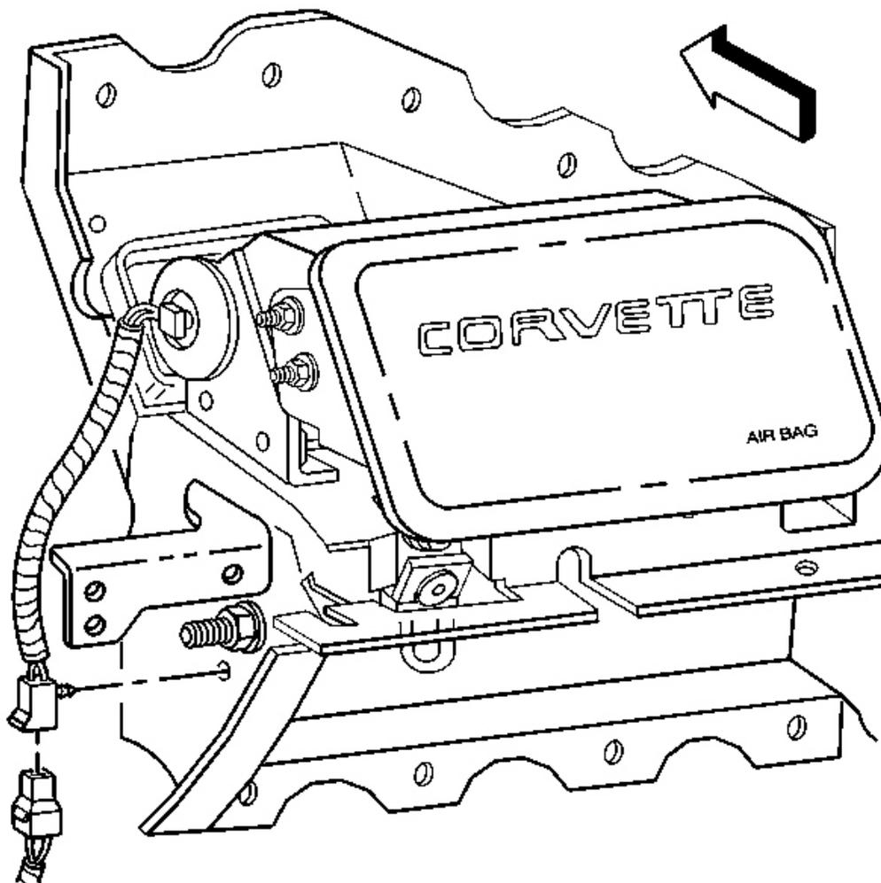
**Fig. 41: I/P Module & Pigtail Connector**
