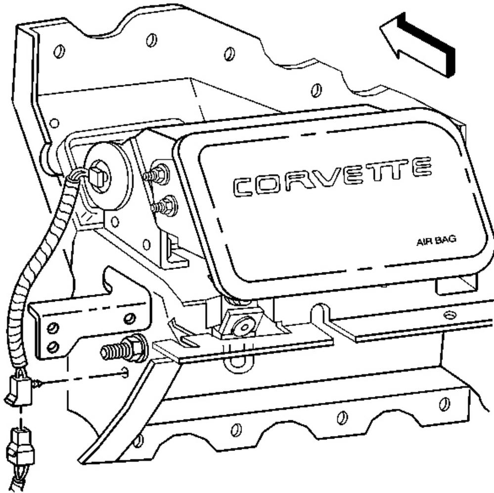
**Fig. 44: I/P Module & Pigtail Connector**
