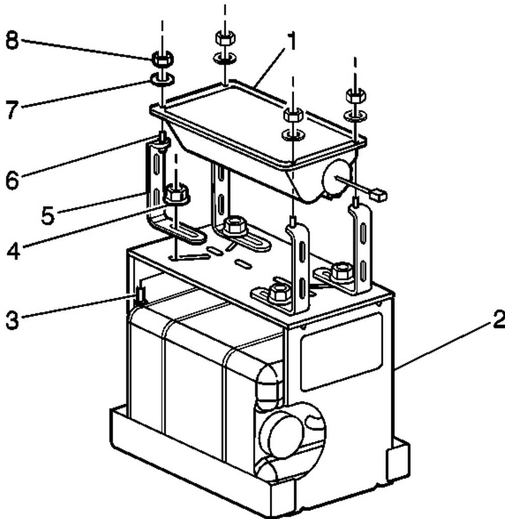
**Fig. 53: I/P Module Components**
