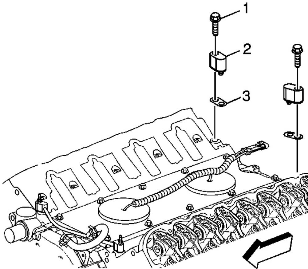
**Fig. 38: Coolant Air Bleed Pipe Covers, Bolts & Gaskets**
