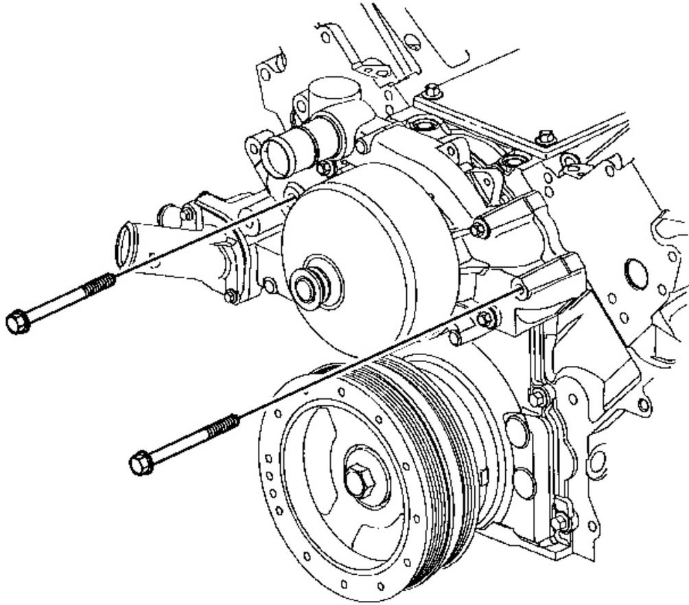
**Fig. 50: Water Pump Bolts**
