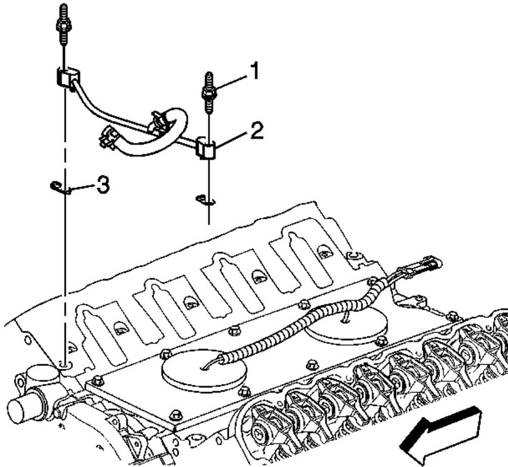
**Fig. 32: Coolant Air Bleed Pipe, Studs & Gaskets**
