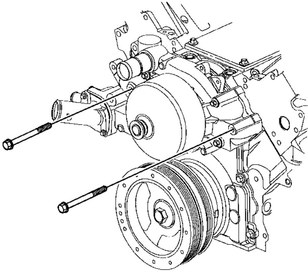
**Fig. 47: Water Pump Bolts**
