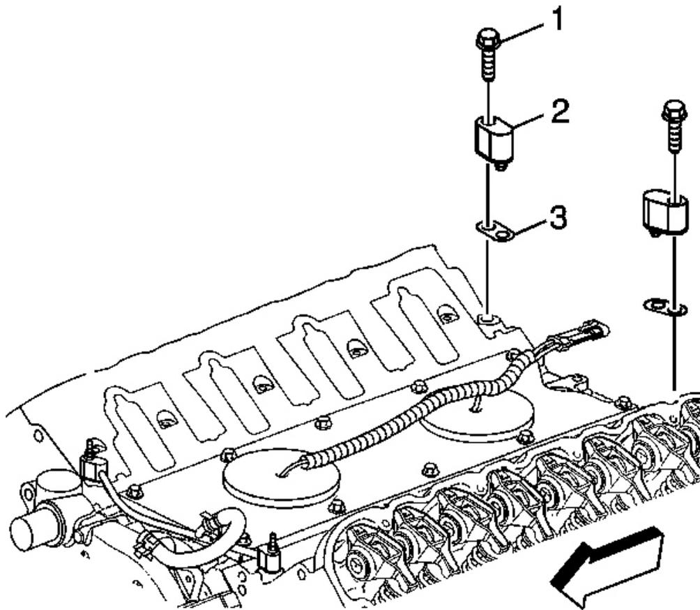
**Fig. 33: Coolant Air Bleed Pipe Covers, Bolts & Gaskets**
