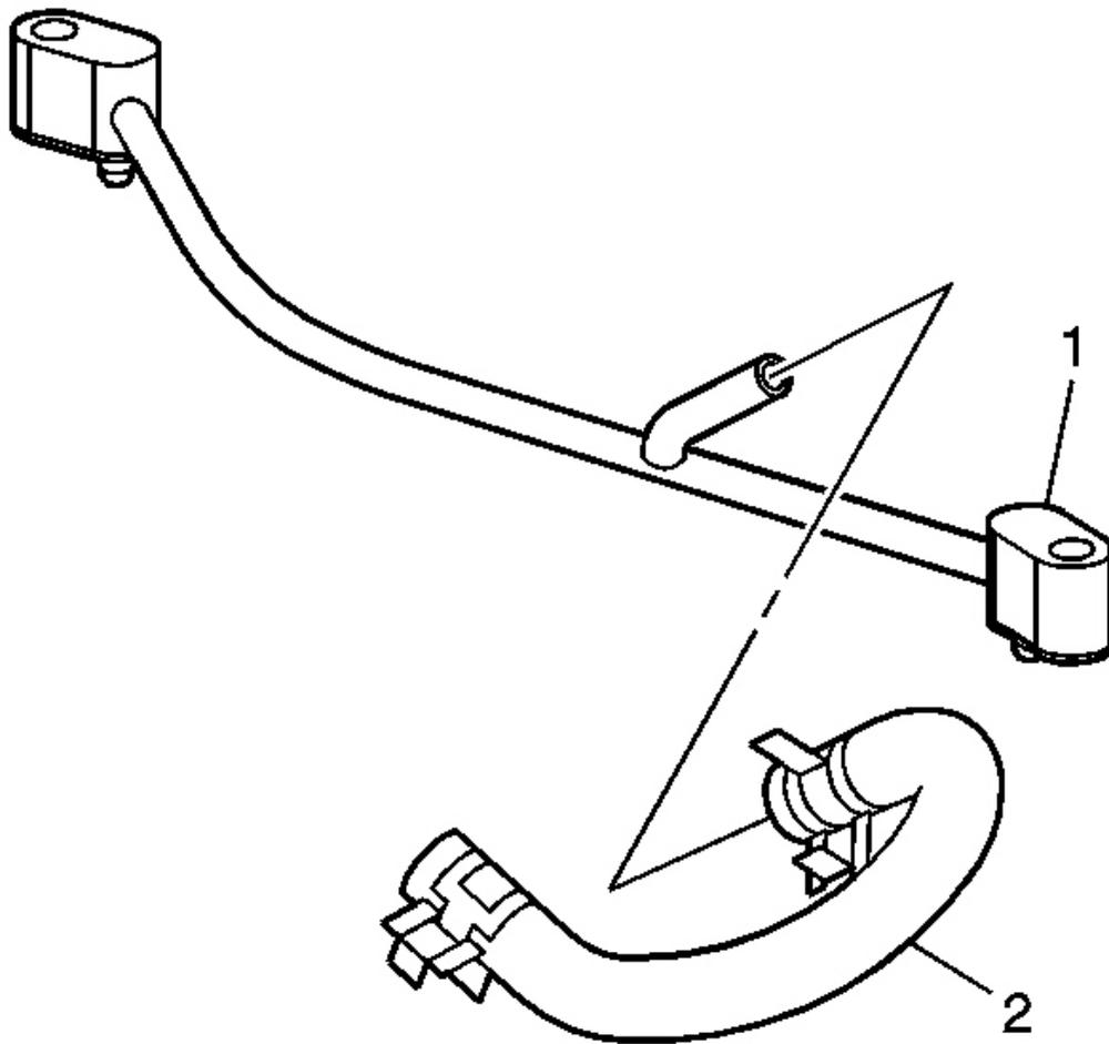
**Fig. 35: Coolant Air Bleed Hose & Pipe**
