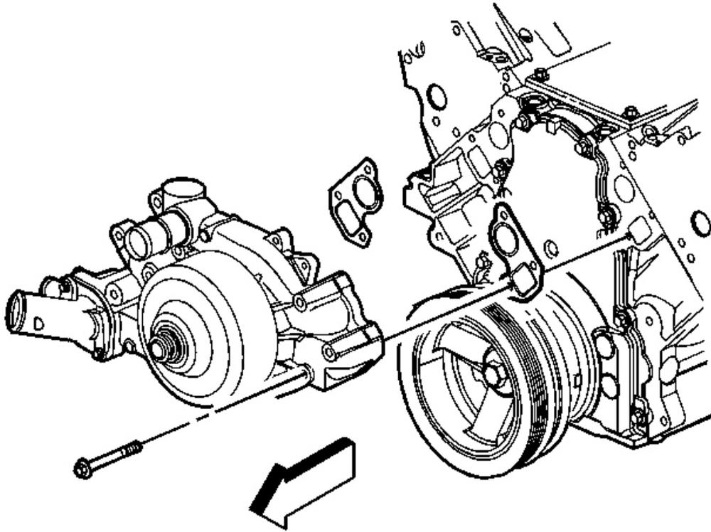
**Fig. 48: Water Pump Gaskets**
