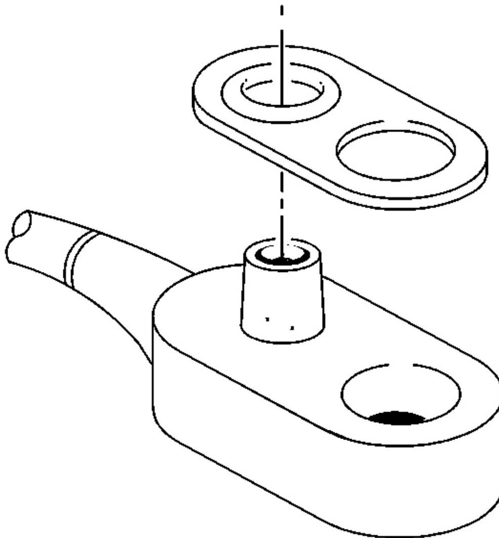
**Fig. 37: Coolant Air Bleed Pipe Gasket**
