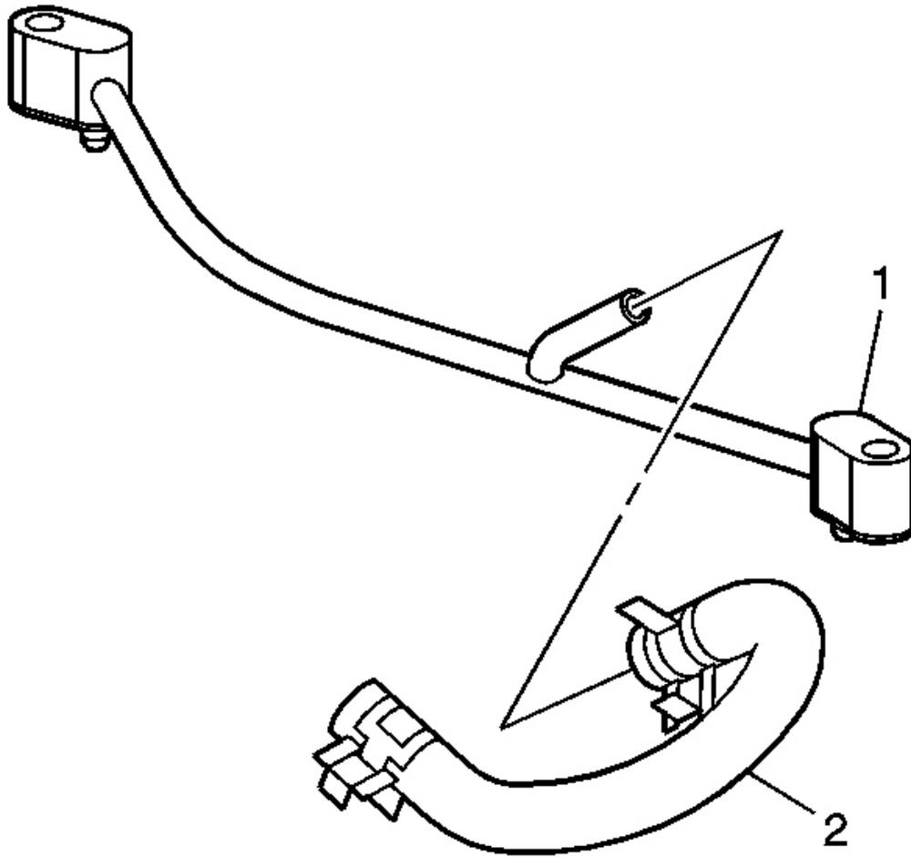
**Fig. 42: Coolant Air Bleed Hose & Pipe**
