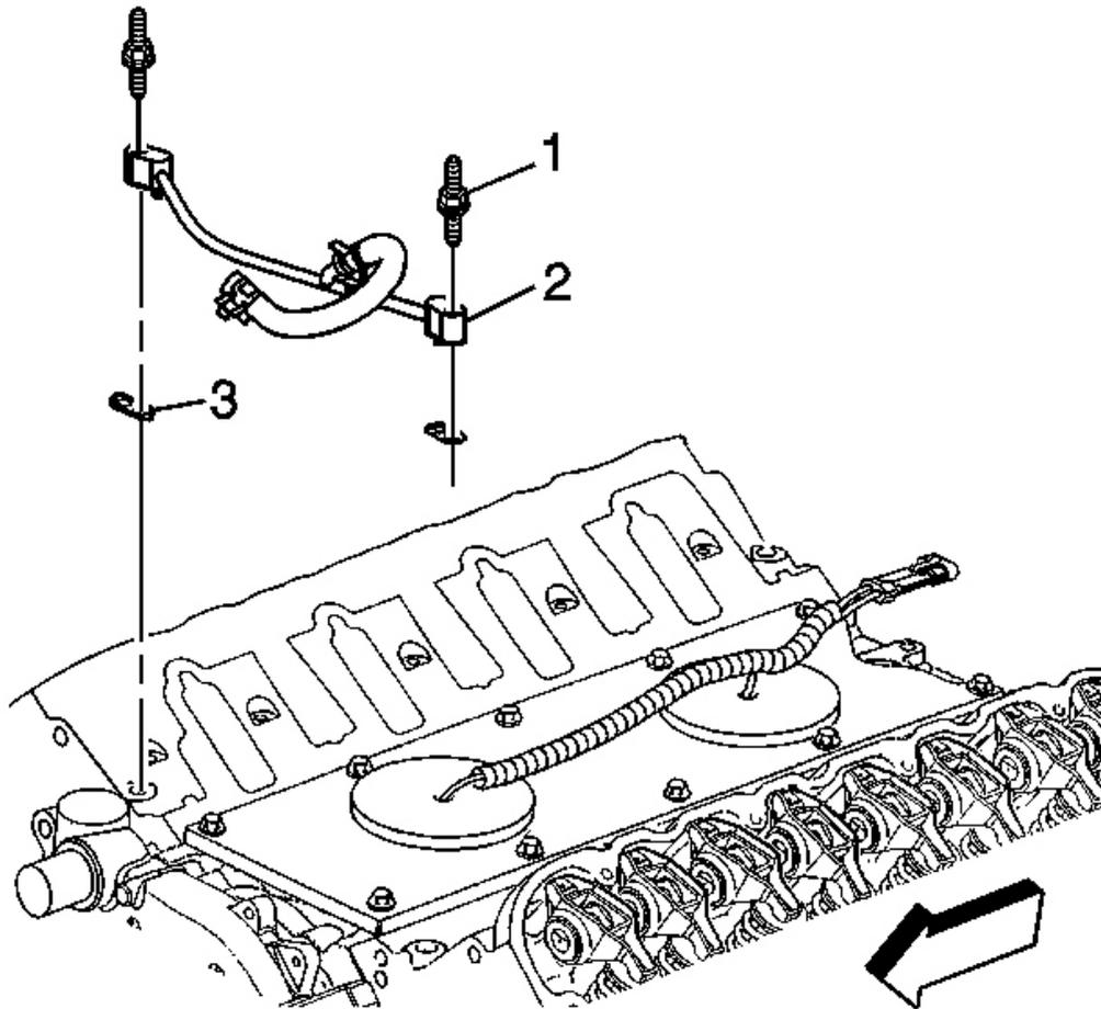
**Fig. 39: Coolant Air Bleed Pipe, Studs & Gaskets**
