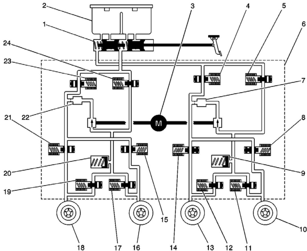
**Fig. 35: BPMV Hydraulic Flow**
