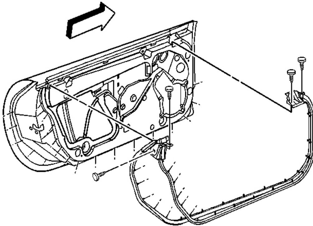
**Fig. 175: Weatherstrip Retainers At Door**
