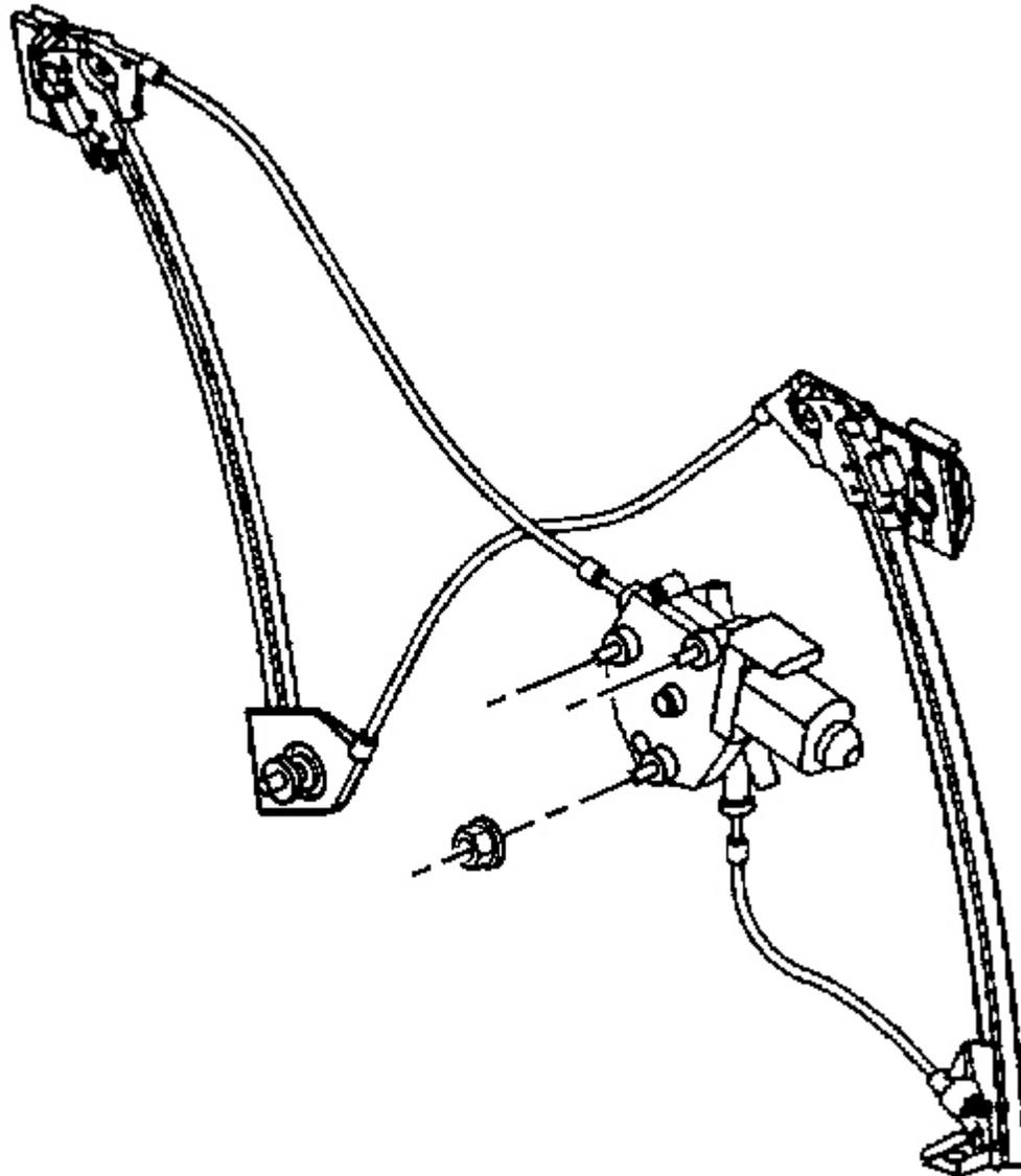
**Fig. 150: Motor Studs At Door Inner Panel**
