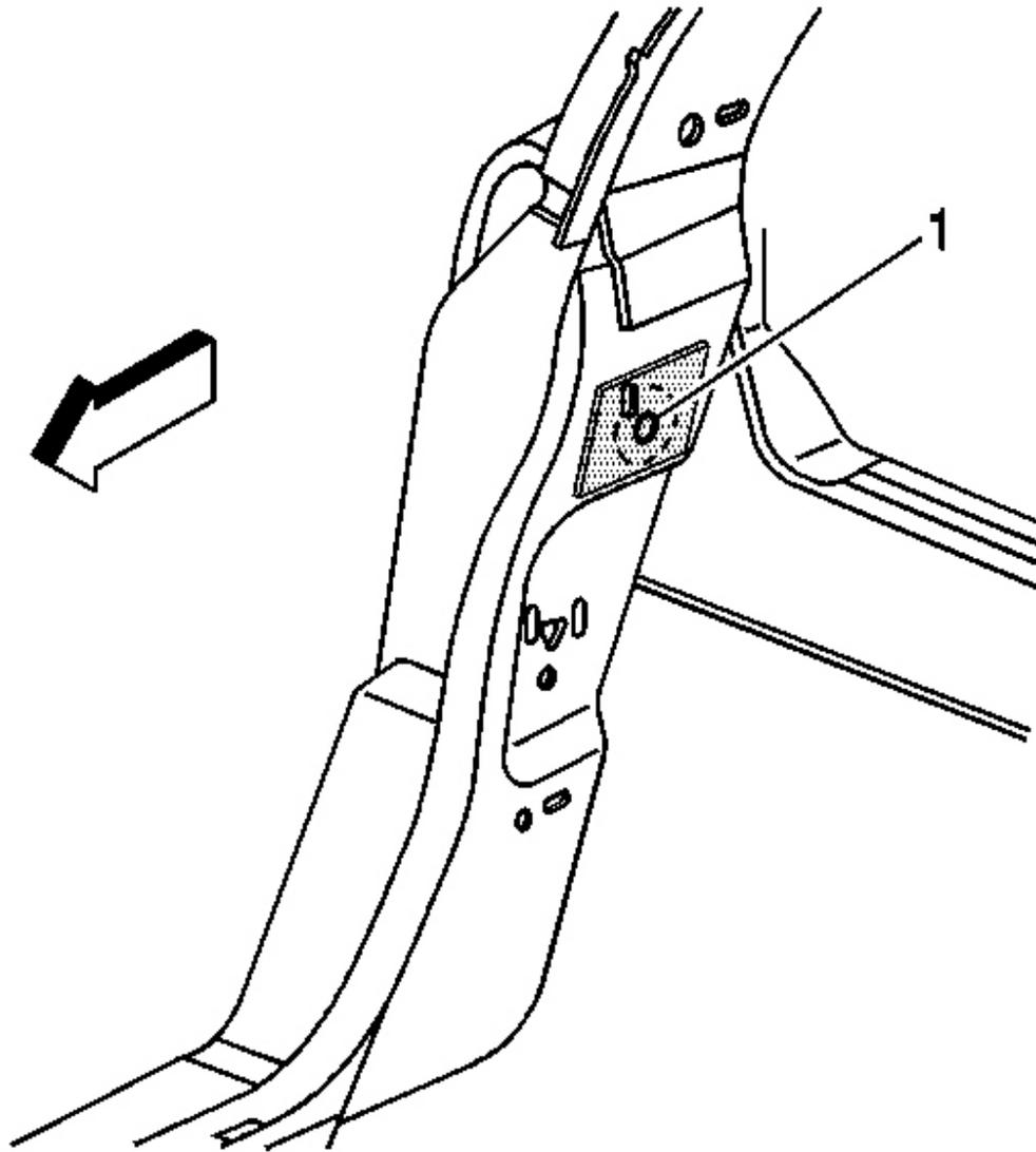
**Fig. 123: Access Hole Plug**
