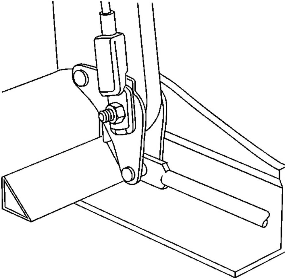
**Fig. 75: Actuators Underneath Seat Frame Springs**
