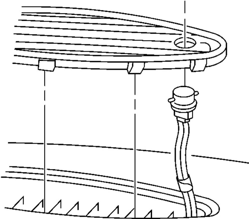
**Fig. 109: Sunload Sensor To Grille**
