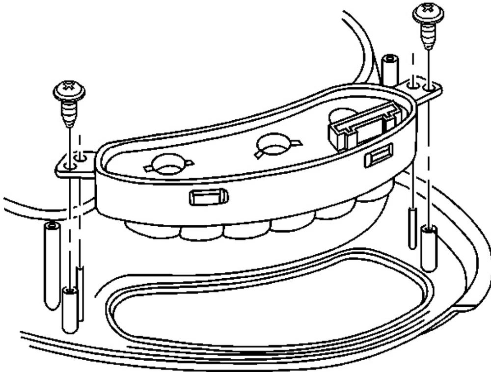
**Fig. 91: DIC Switch To I/P Cluster Bezel**
