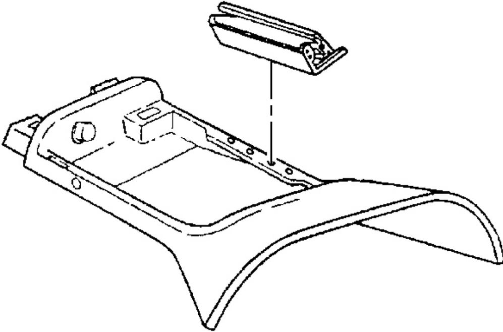
**Fig. 210: Hinge To Console**
