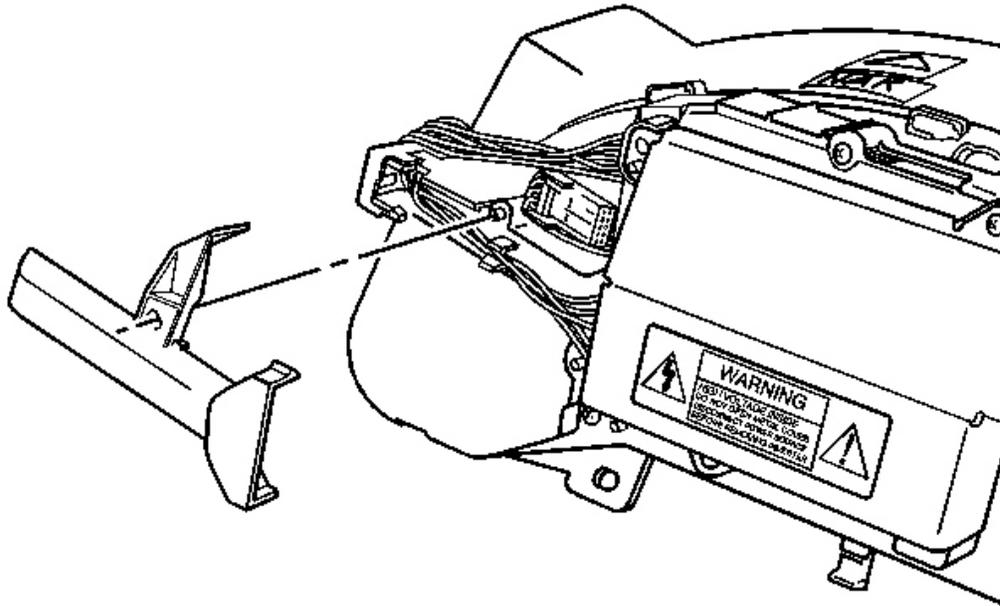
**Fig. 201: UV Inverter Wiring Covers**
