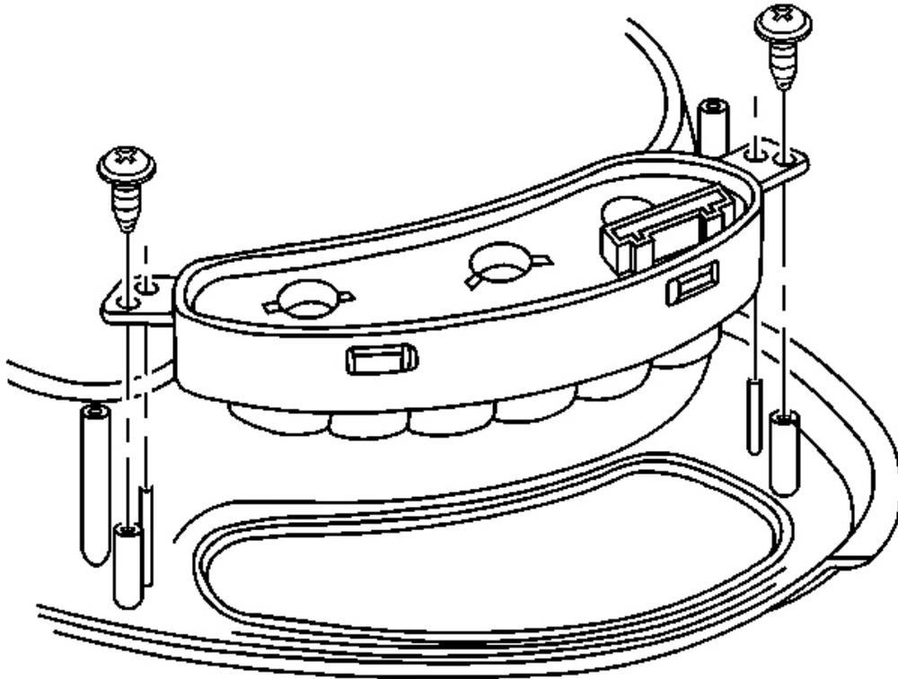
**Fig. 188: DIC Switch To I/P Cluster Bezel**
