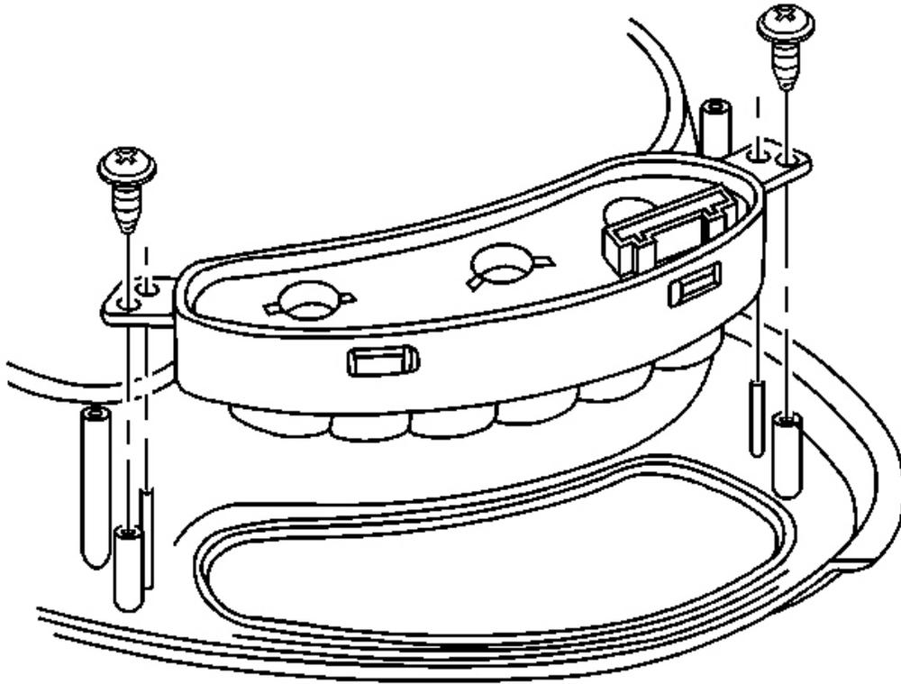
**Fig. 187: DIC Switch To I/P Cluster Bezel**
